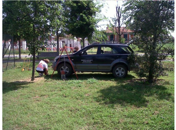
Energizzazioni in SH con pendolo e masse da 30 kg
