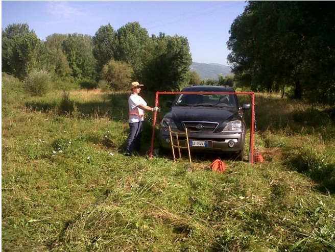
Energizzazioni in SH con pendolo e masse da 30 kg
