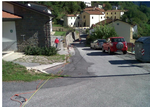
Profilo sismico per la verifica sismica della scuola di Treppio (Sambuca P.se)
