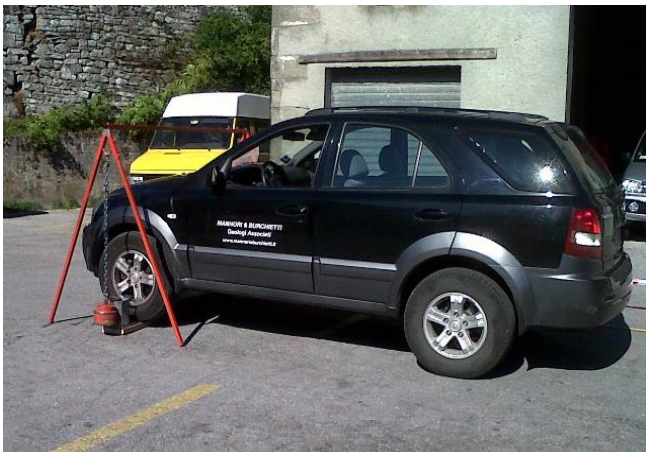
Profilo sismico per la verifica sismica della scuola di Treppio (Sambuca P.se)
