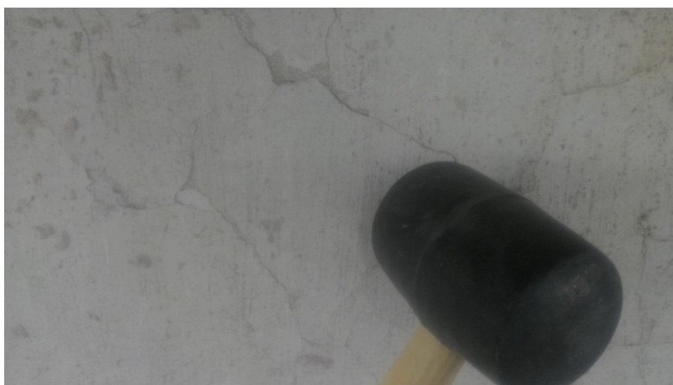
Foto 2 – Battitura con martello di gomma
