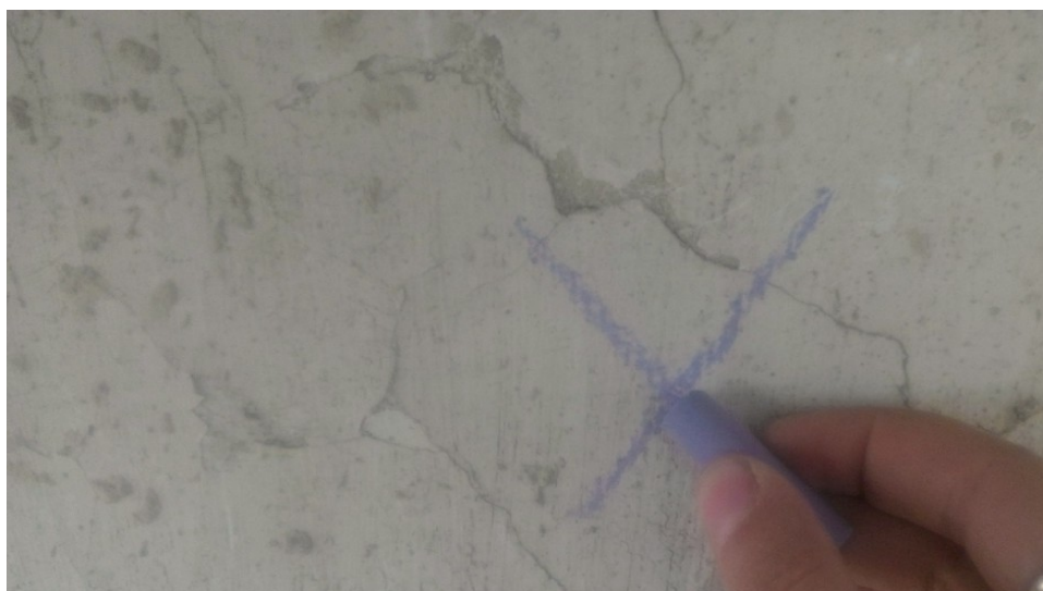
Foto 3 – Segnatura zone di intonaco con presenza di sacca di vuoto sottostante
