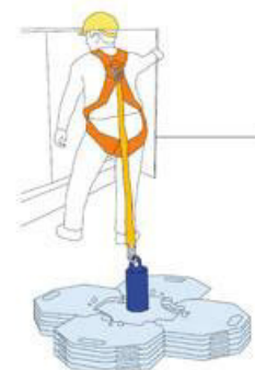
Immagine esemplificativa di dispositivo di ancoraggio provvisorio di classe E (UNI EN 795) a corpo morto
